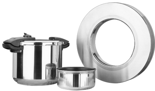
环形冲压模 (内径 300mm)
